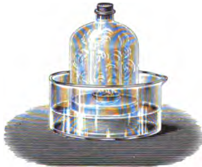
Stickstoff aus Luft durch brennenden Phosphor.
